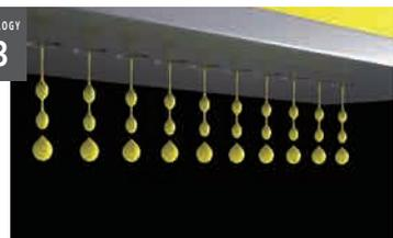
センサーからの情報をもとに、高速で搬送する用紙にインク滴を速く、正確に着弾するようコントロールします。
